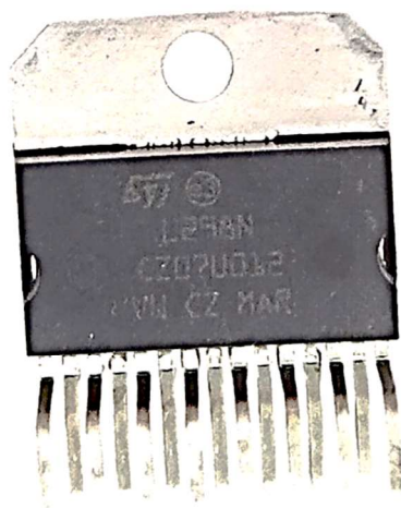
Rys. 2.18. Fragment noty technicznej obudowy Multiwatt-15
