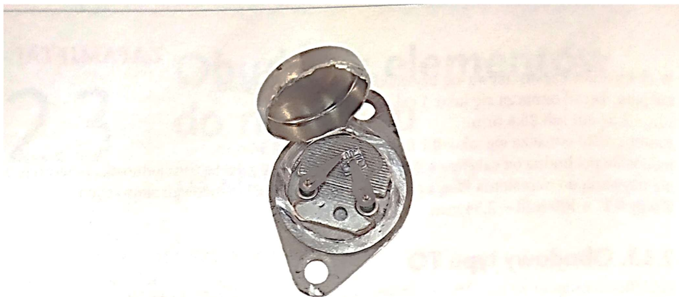
Rys. 2.13. Obudowa TO-3 ze zdjętą osłoną; widoczne wewnątrz tranzystora
