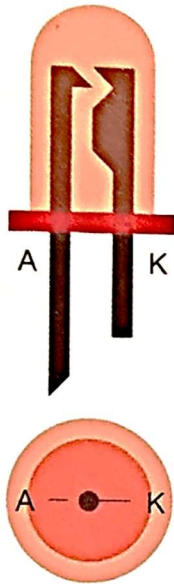
Rys. 2.59. Dioda LED jednokolorowa: u góry – widok z boku, na dole – widok z góry
